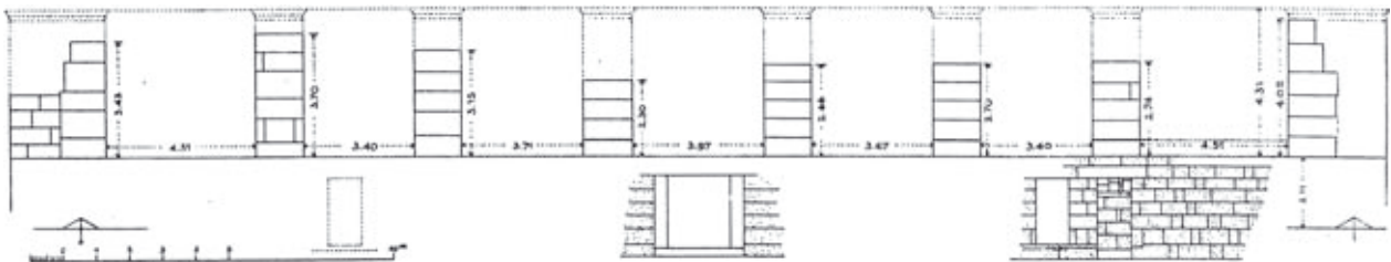
Abb. 752: Bühnengebäude, Erhaltungszustand der ›Thyromata-Wand‹ (Phase 2) (nach HEBERDEY u. a. 1912)
